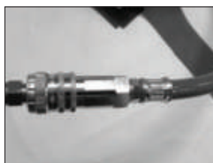
Raccordement du tuyau à l'ARI
